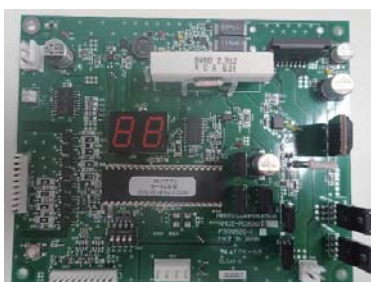
C 3 5 カーテン制御基板
