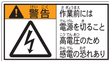
F 9 作業前警告ラベル
