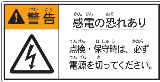
F 7 感電警告点検ラベル
